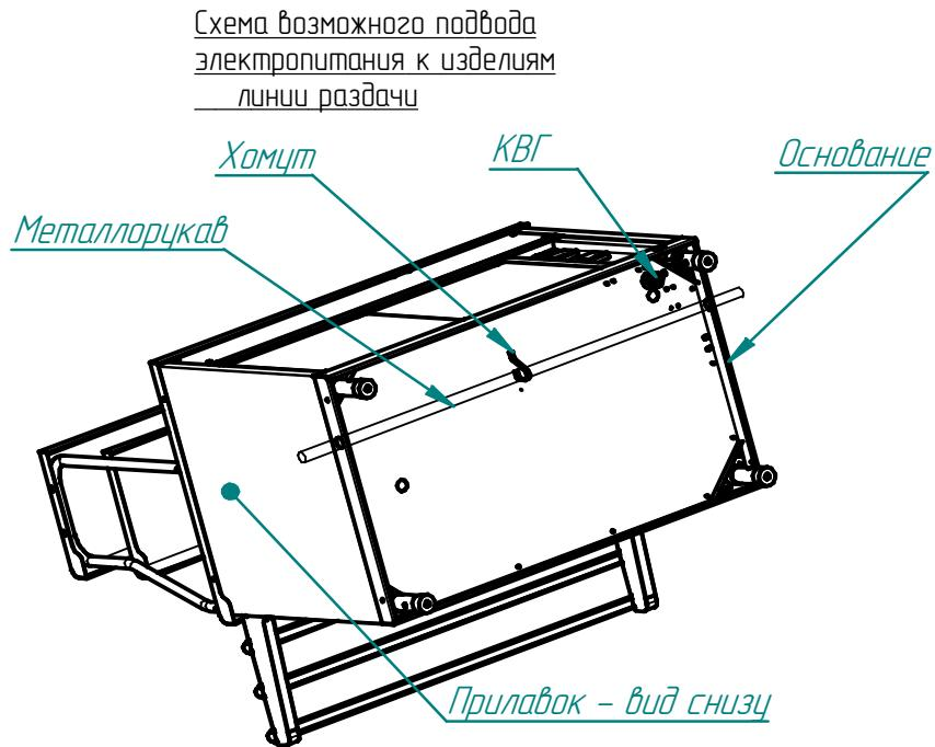
В основаниях изделий линии раздачи введенено сквозное отверстие диаметром 29,5 мм и поддерживающие хомуты для возможности проведения металлического кабеля с питательными кабелями сквозь все изделия линии раздачи.
