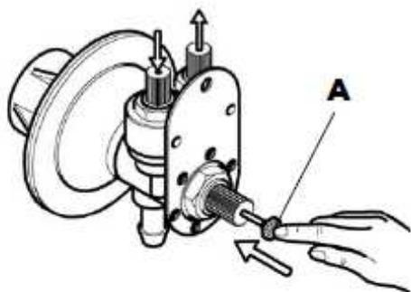
Перед регулировкой необходимо наполнить дозатор и шланг с помощью кнопки прокачки (А).
