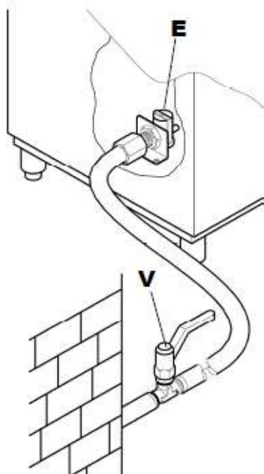
Обеспечить подключение в соответствии с представленной водопроводной схемой подключения.
