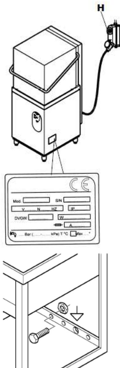
1. Подключение к сети питания должно производиться посредством главного выключателя (H), который должен быть омниполярным и обеспечивать прерывание всех контактов, включая нулевой. Расстояние между разомкнутыми контактами должно быть не меньше 3 мм, при этом в обязательном порядке следует использовать термомангнитный автоматический выключатель или плавкие предохранители, рассчитанные на максимальную мощность согласно паспортной табличке.
