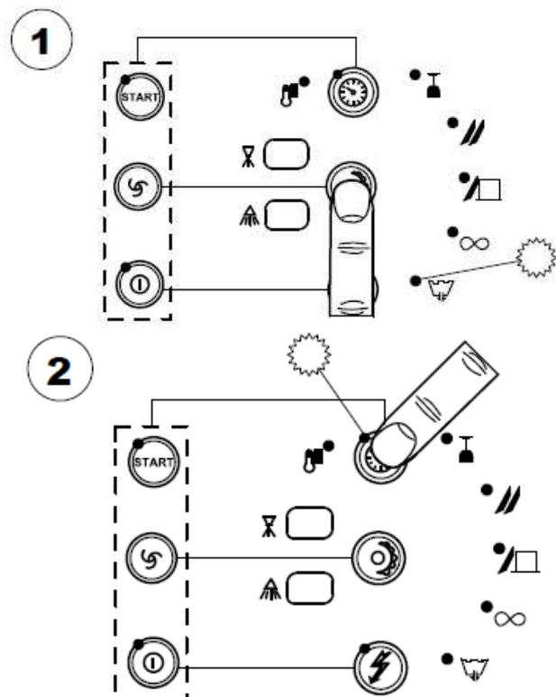
1. Нажать кнопку, обозначенную слева/справа, и выбрать программу слива (загорится соответствующий индикатор).
