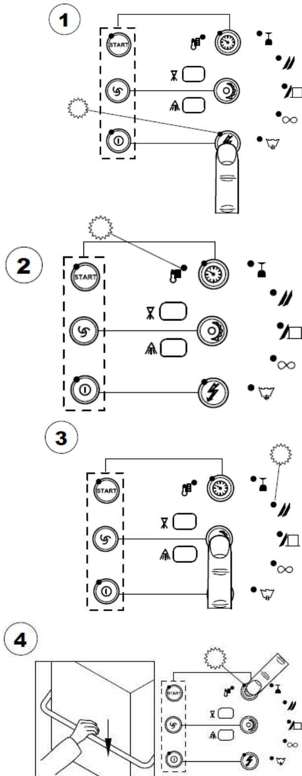
1. Для включения машины нажать кнопку, обозначенную слева/справа (загорится соответствующий индикатор).
