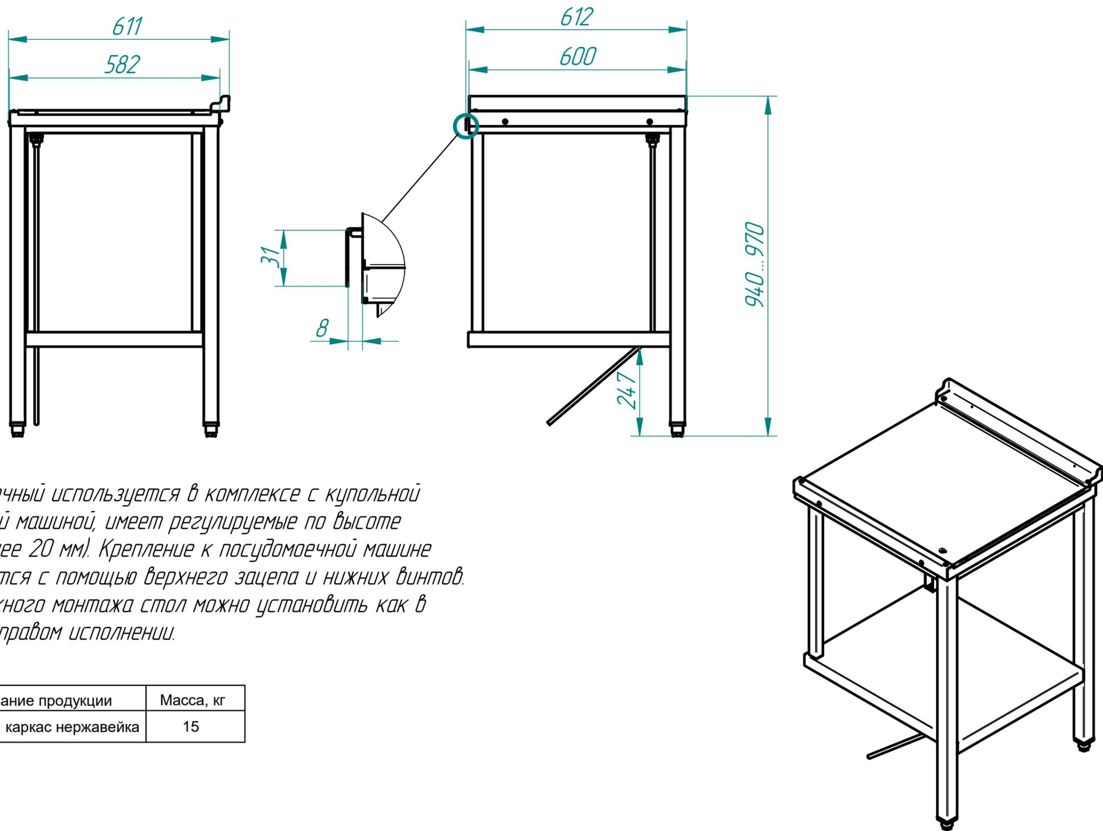
*Стол раздаточный используется в комплексе с купольной посудомоечной машиной, имеет регулируемые по высоте ножки (не менее 20 мм). Крепление к посудомоечной машине осуществляется с помощью верхнего зацепа и нижних винтов. Путем несложного монтажа стол можно установить как в левом, так и правом исполнении.*
