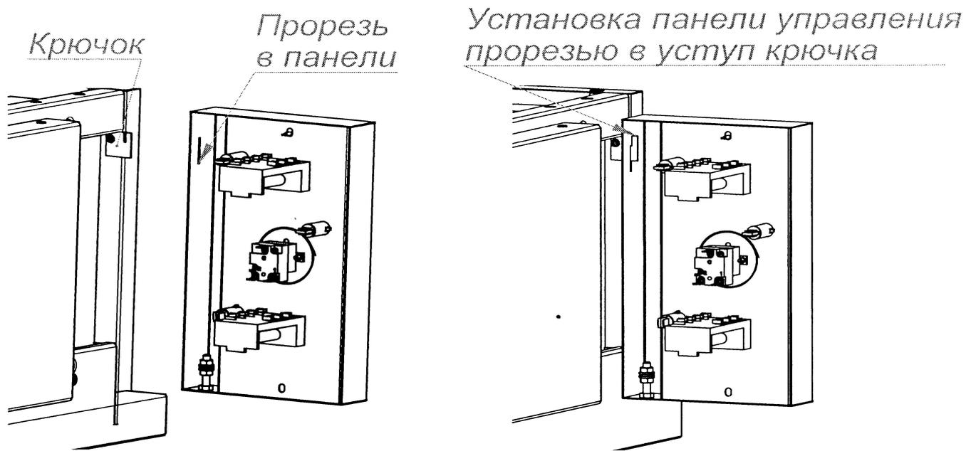
Рис. 9 Схема установки панели управления при ТО
