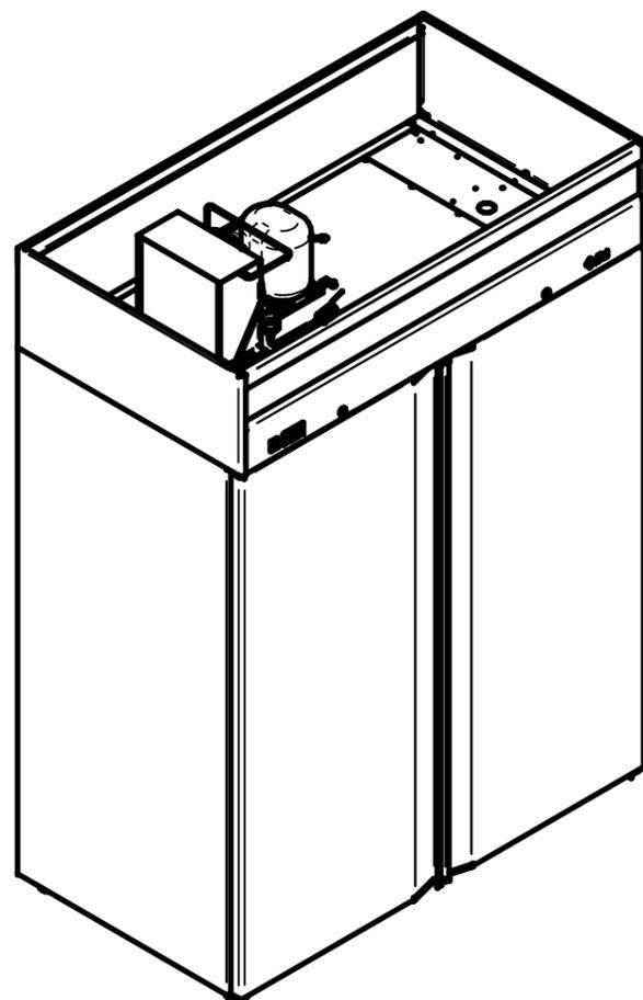
Шкафы холодильные типа ШХ-1,4 (ШХн-1,4; ШХс-1,4) с верхним расположением агрегата предназначены для хранения пищевых продуктов в охлажденном или замороженном состоянии на предприятиях общественного питания и торговли.
