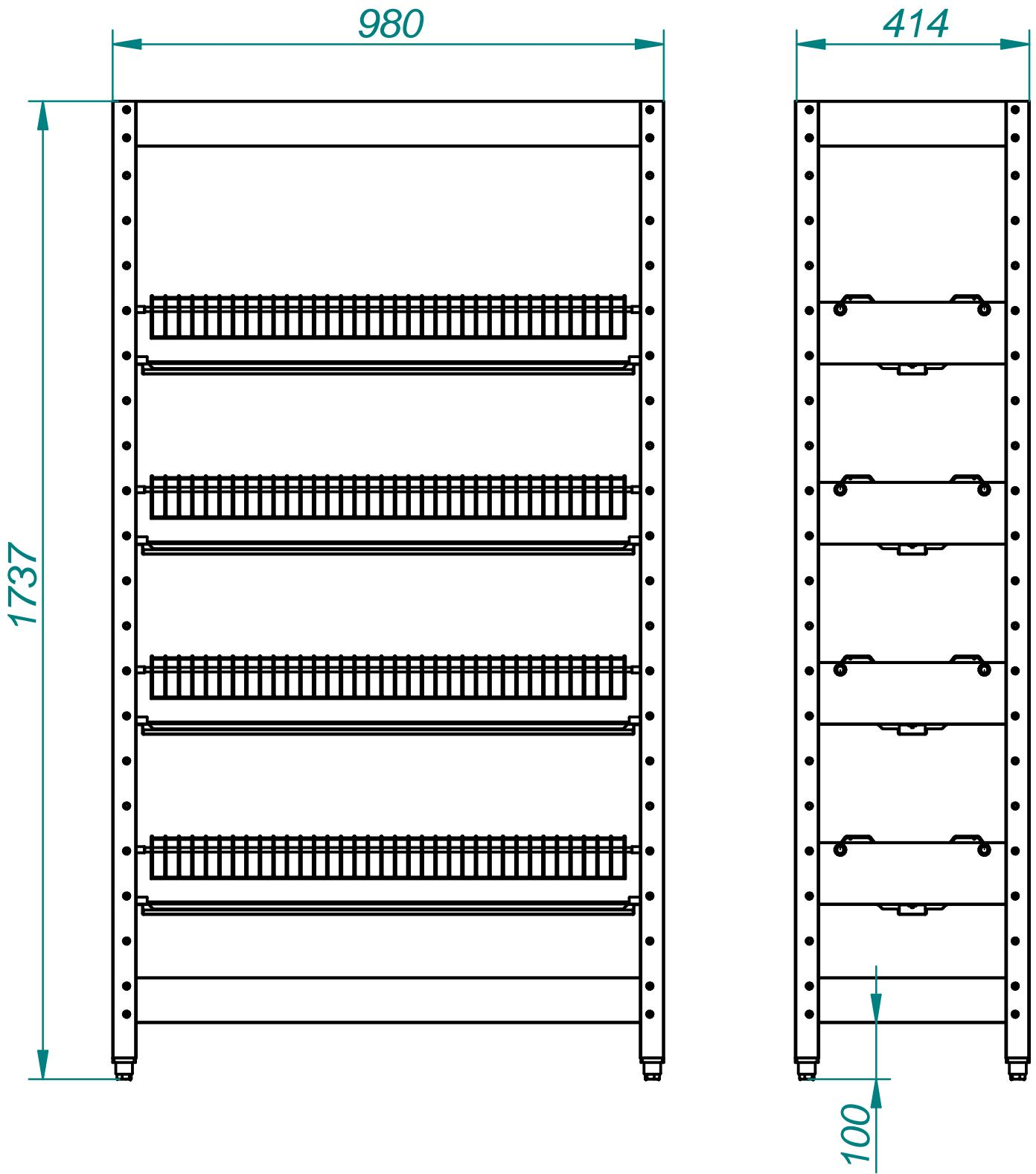
Стеллаж для сушки тарелок ССТ-4-2 с лотком для сбора воды предназначен для сушки и хранения тарелок на предприятиях общественного питания. Все элементы стеллажа изготовлены из нержавеющей стали. Под каждой кассетой установлен пластиковый лоток. Стеллаж имеет регулируемые по высоте пластмассовые ножки с резиновыми вставками. Конструкция стеллажа разборная.
