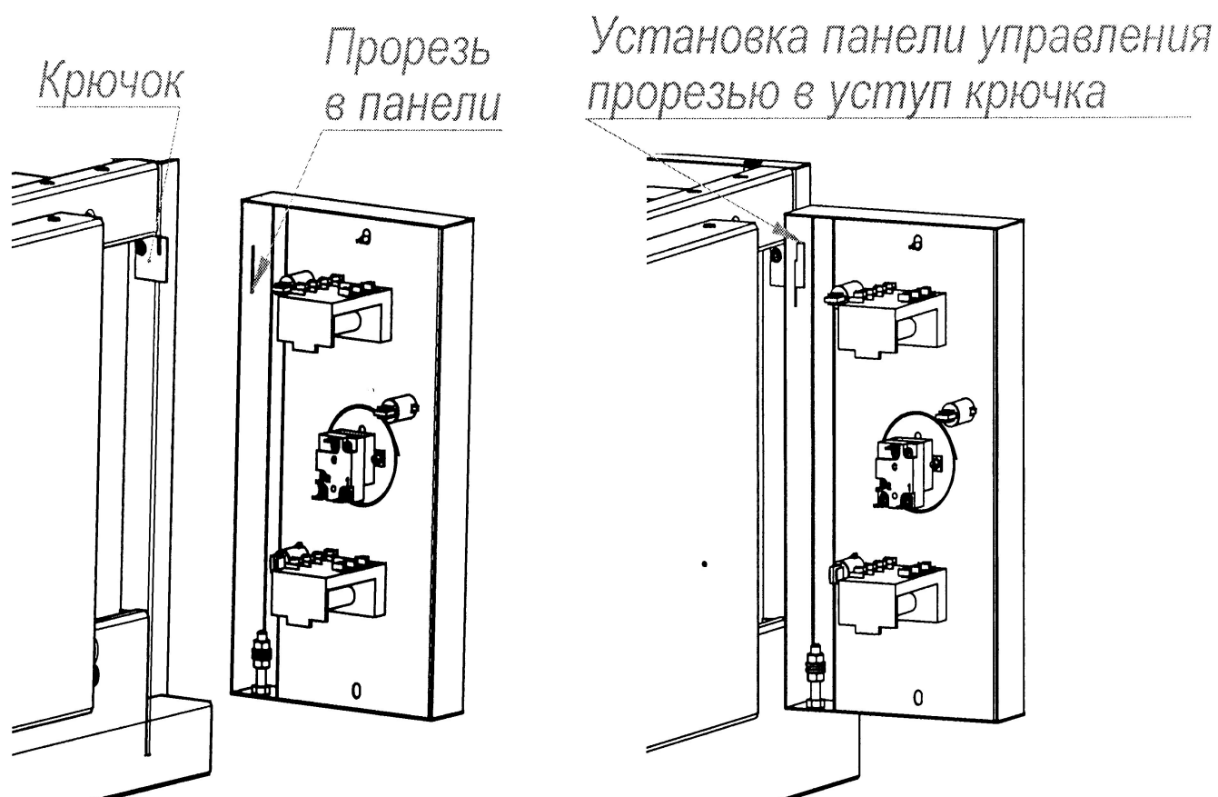
Рис.5 Схема установки панели управления при ТО
