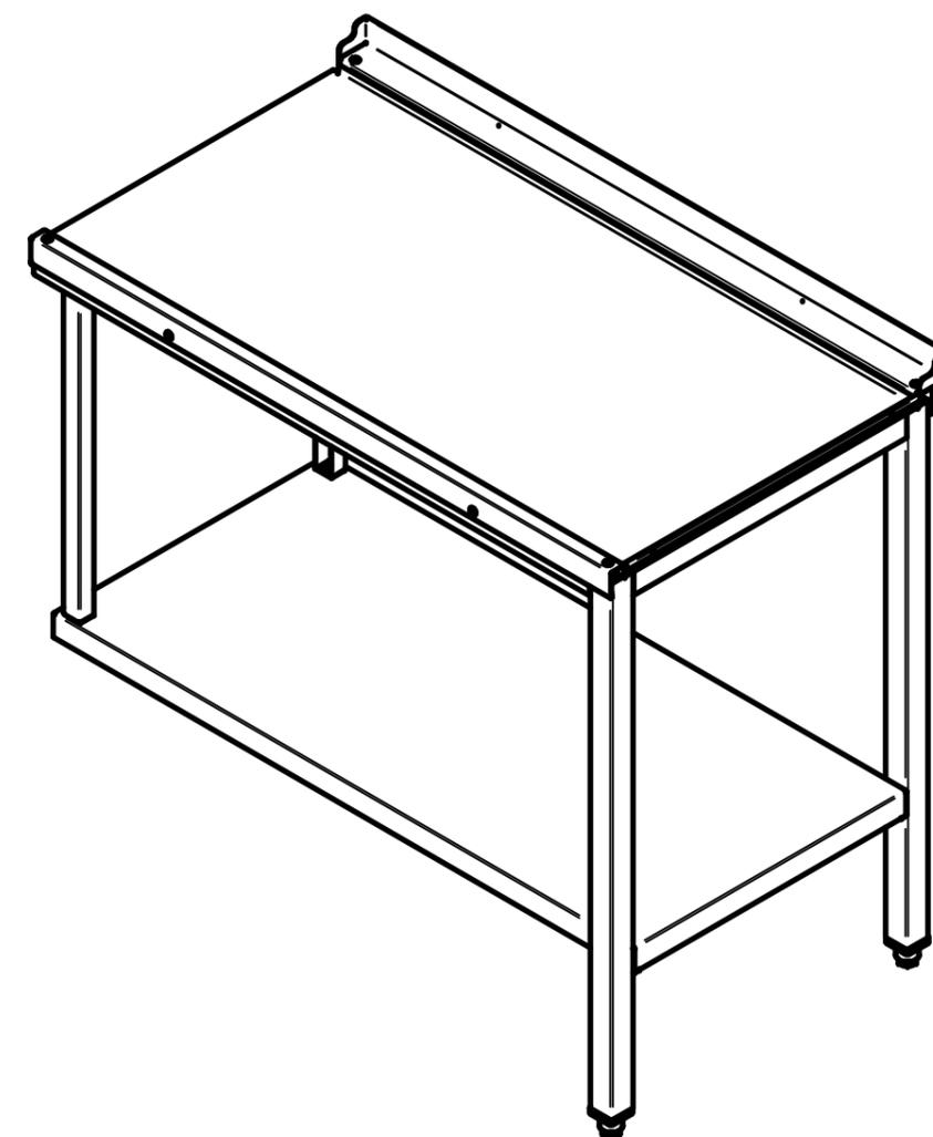
*Стол раздаточный используется в комплексе с купольной посудомоечной машиной, имеет регулируемые по высоте ножки (не менее 20 мм). Крепление к посудомоечной машине осуществляется с помощью верхнего зацепа и нижних винтов. Путем несложного монтажа стол можно установить как в левом, так и правом исполнении.*
